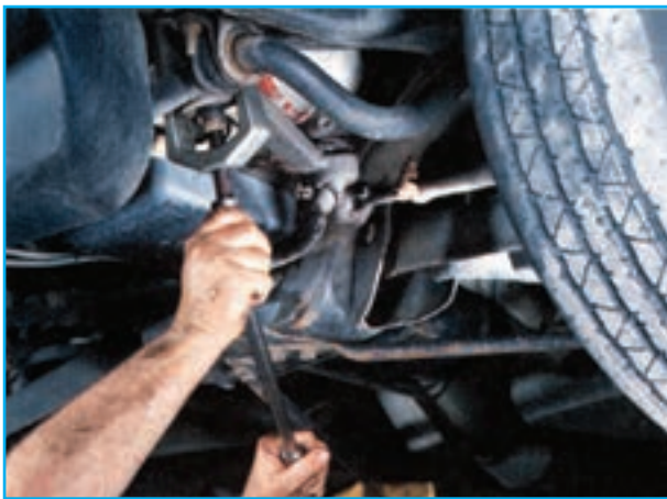
شکل ۴۷-۲- نحوه استفاده از نوعی سیبک کش
