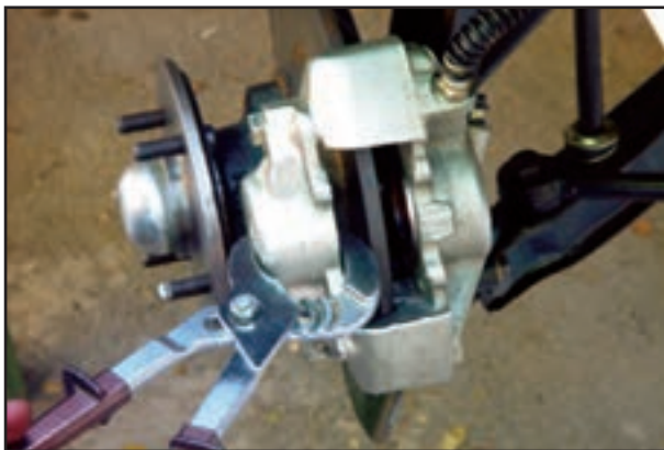
شکل ۱۱۴-۱- عقب راندن پیستون ترمز دیسکی
