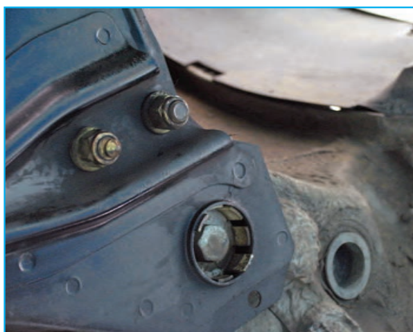
شکل ۳-۱۲۲- باز کردن پیچ های طبق
