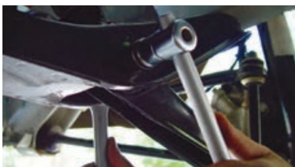
شکل ۳-۸۳- باز کردن طبق از رام
