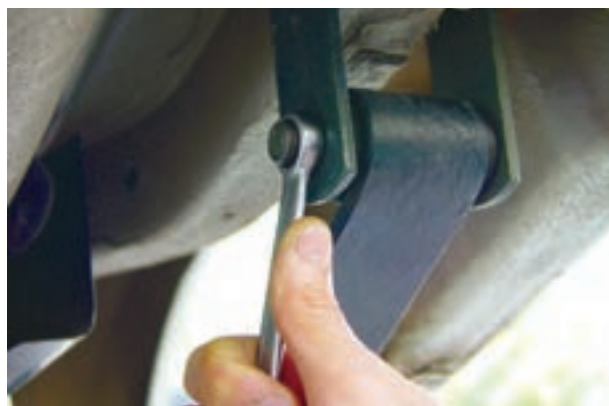
شکل ۳-۶۵ – باز کردن مهره‌های گوشواره فنر شمش
