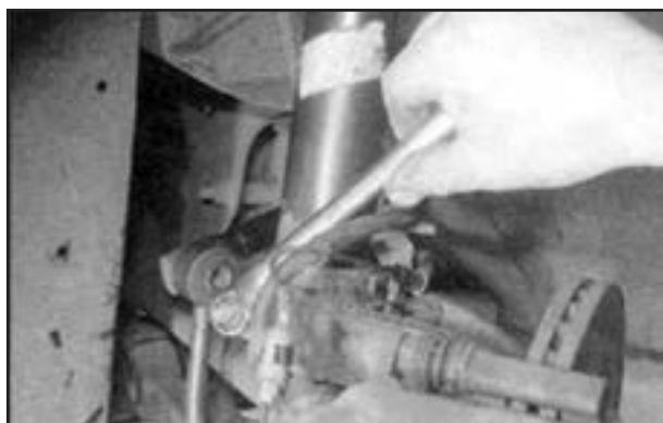
شکل ۱۳۵-۳- باز کردن پیچ و مهره اتصال کمک فنر به نگهدارنده
