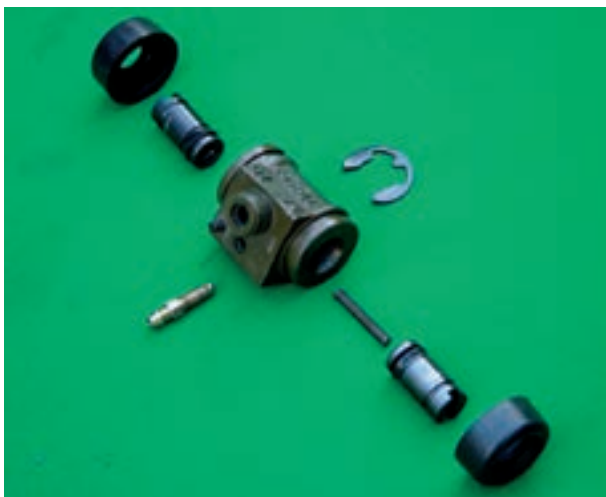
شکل ۹۵-۱- اجزای پمپ ترمز چرخ
