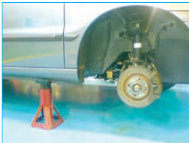
شکل ۳-۶۱- خودروی مستقر بر پایه قابل تنظیم
