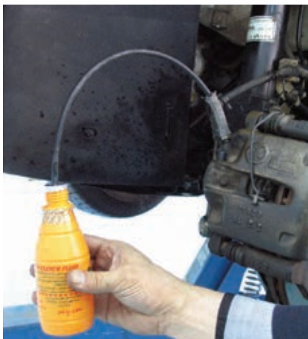
شکل ۱-۷۱- نصب لوله پلاستیکی روی پیچ هواگیری
