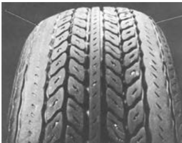
شکل ۲۱۴-۳- سایش در اثر رانندگی غلط (پیچیدن تند)
