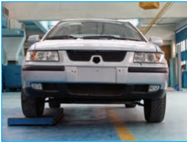
شکل ۱۹-۳ مزایای سیستم تعلیق مستقل
