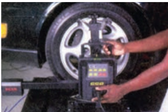
شکل ۳-۲۲۰- نصب مجموعه حسگر دستگاه اندازه‌گیر رایانه‌ای
