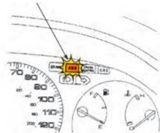
شکل ۱-۱۶۱- چراغ اخطار ترمز ضد قفل (ABS)
