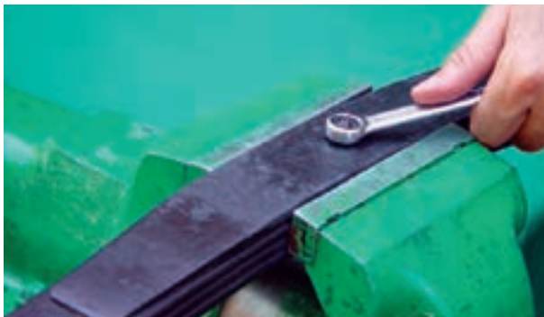
شکل ۳-۶۸- باز کردن پیچ مرکز فنرهای شمش
