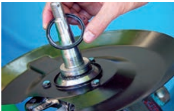
شکل ۳-۹۵- خارج کردن کاسه نمد پشت توپی چرخ
