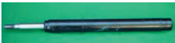
شکل ۳-۹۲- کمک فنر قابل تعویض
