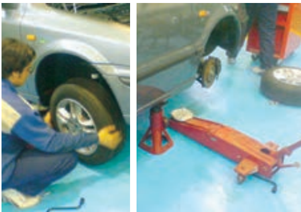
شکل ۱۱۷-۱- بالا بردن و پیاده کردن چرخ جلو
