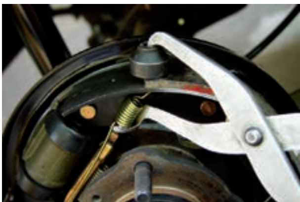
شکل ۱-۱۰۷- جازدن فنر بالایی کفشک
