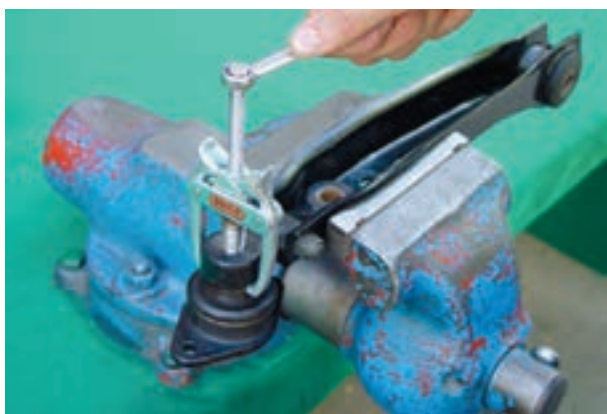
شکل ۳-۸۵- جدا کردن سیبک از بازوی اتصال
