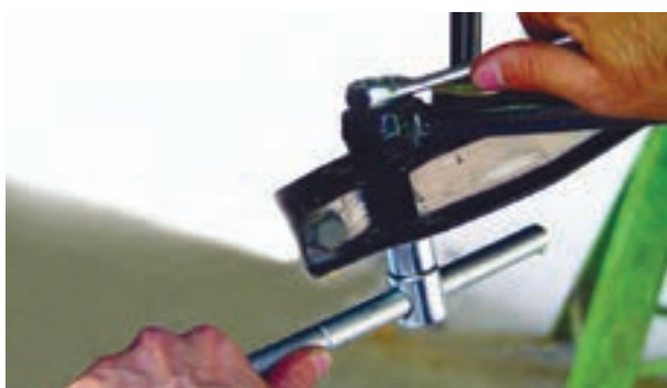
شکل ۳-۸۱ باز کردن میل تعادل از طبق
