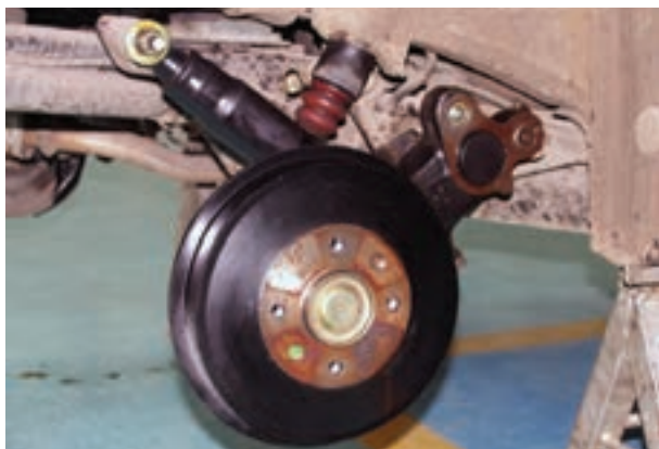
شکل ۱۷۷-۳- نصب کمک فنر
