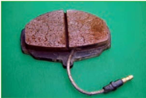
شکل ۱۱۲-۱- لنت ترمز دارای سیم هشدار
