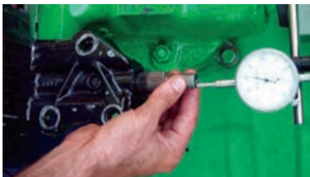
شکل ۷۰-۲- اندازه‌گیری لقی طول محور هزار خار
