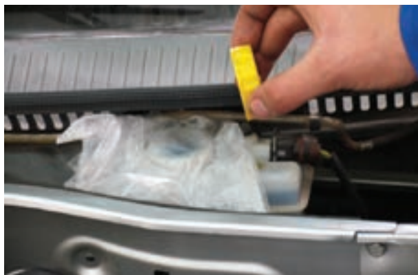
شکل ۱۳۸-۱- مسدود کردن در مخزن مایع ترمز
