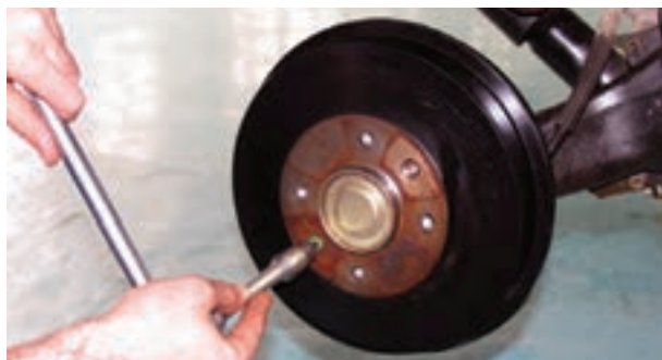
شکل ۱-۸۹ – باز کردن پیچ کاسه چرخ
