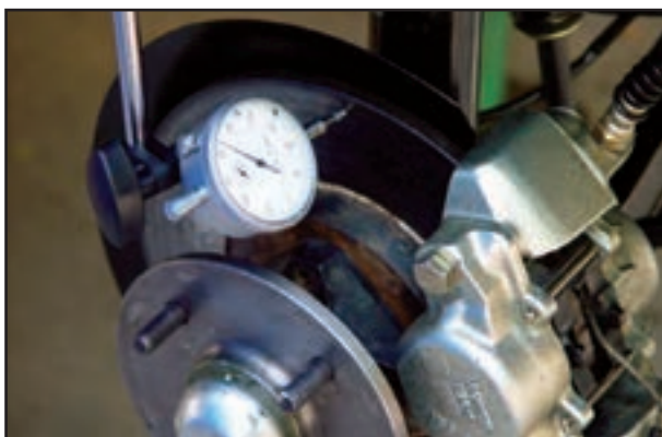
شکل ۱-۱۲۳- بررسی وضعیت دیسک
