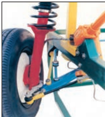
شکل ۳-۵۶- سیستم تعلیق جلو مستقل با کمک فنر و محور متحرک
