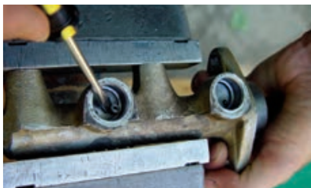
شکل ۱-۱۳۱- بستن سیلندر اصلی به گیره
