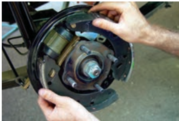
شکل ۱۰۴-۱- خارج کردن کفشک‌ها
