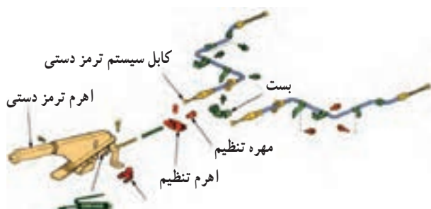
شکل ۱-۴۶-ا. اجزای سیستم ترمز دستی
