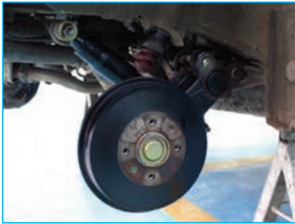
شکل ۱۸۳-۳- نصب ژامبون و متعلقات چرخ عقب
