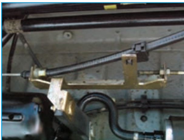
ب - باز کردن اجزای ترمز دستی در زیر خودرو
