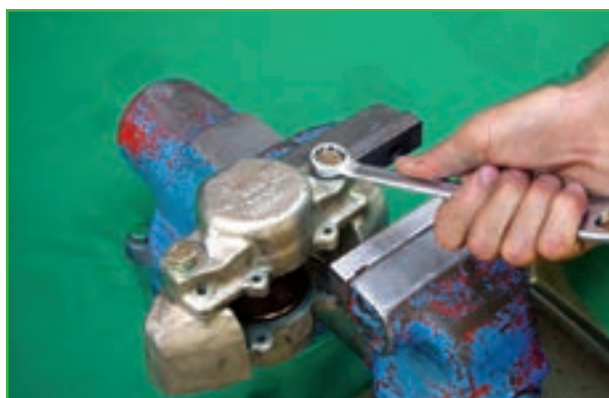
شکل ۱-۱۲۰- باز کردن پیچ های کالیپر
