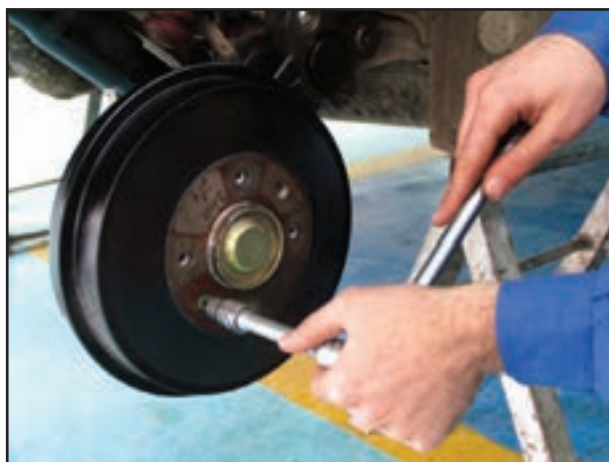
شکل ۱-۱۰۲- بستن پیچ نگه‌دارنده کاسه چرخ
