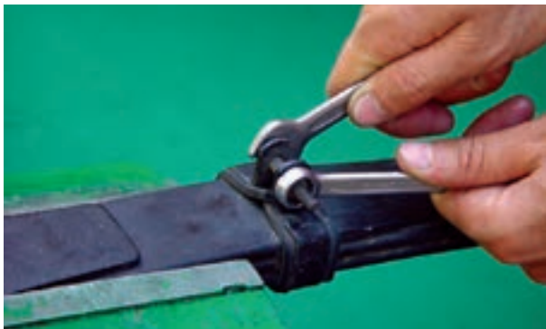
شکل ۳-۶۷- باز کردن بست‌های مجموعه فنر شمش
