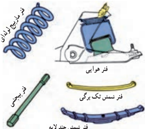
شکل ۳-۲۴ – انواع فنرهای مورد استفاده در خودرو
