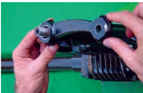
شکل ۲-۵۹- پیاده کردن اهرم هزار خار
