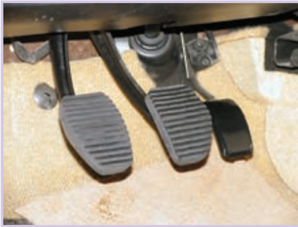
شکل ۱-۱۵- مجموعه پدال‌های ترمز و کلاچ
