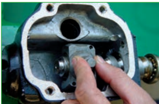
شکل ۲-۶۳- خارج کردن محفظه ساچمه‌ها
