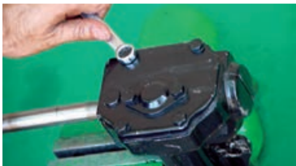
شکل ۲-۶۲- باز کردن درپوش بالایی جعبه فرمان
