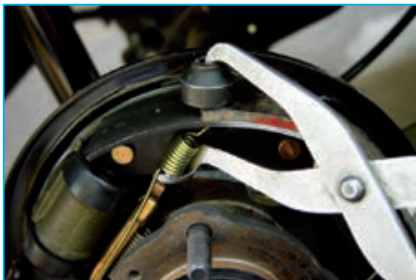
شکل ۹۱-۱- خارج کردن فنر بالایی
