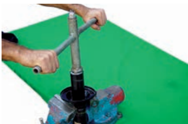
شکل ۳-۹۱- باز کردن مهره نگه‌دارنده کمک فنر
