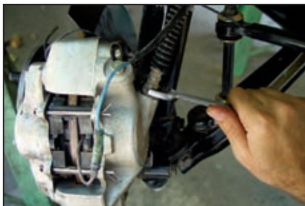
شکل ۱-۱۱۹- باز کردن شیلنگ ترمز
