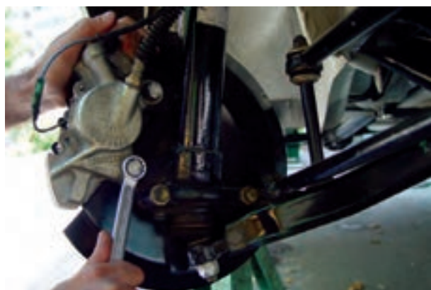
شکل ۳-۷۷- باز کردن کالیبر ترمز
