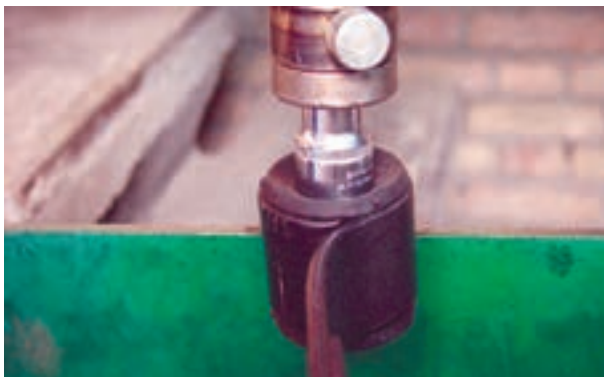
شکل ۳-۶۹- بوش لاستیکی فلزی محل اتصال شاه فنر
