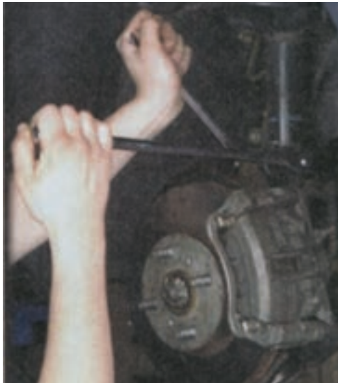
شکل ۳-۱۰۰ نصب مجموعه سیستم تعلیق روی خودرو
