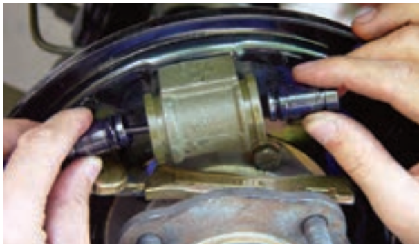
شکل ۹۴-۱- خارج کردن پیستون‌ها
