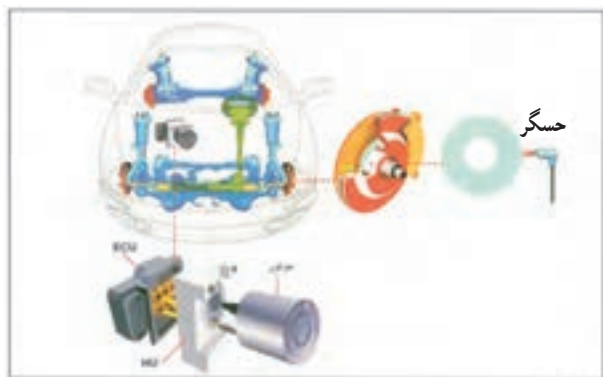
شکل ۱-۱۵۷- اجزای سیستم ترمز ضد قفل (ABS)
