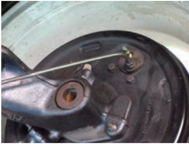
شکل ۱۰۳-۱- پاک کردن اطراف اتصالات
