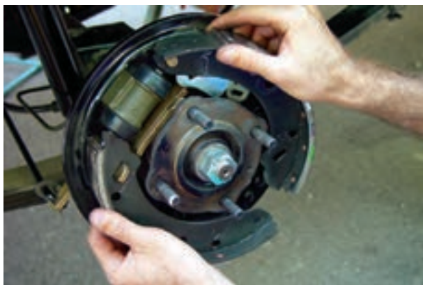
شکل ۹۳-۱- خارج کردن کفشک‌ها
