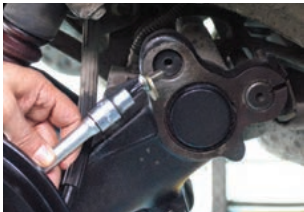
شکل ۱۷۶-۳- نصب واشر فشار و بیج‌های انتهای میله‌ها
