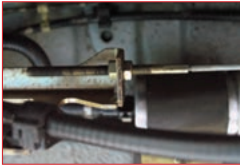
شکل ۴۸-۱- باز کردن مهره تنظیم کننده
