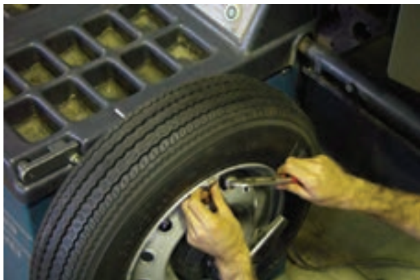
شکل ۲۳۸-۳- نصب وزنه روی قسمت بیرونی رینگ
