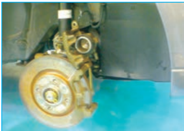
شکل ۱۱۰-۱- باز کردن پوسته نگاه‌دارنده لنت‌ها
