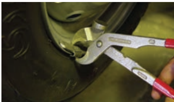
شکل ۲۳۳-۳- تمیز کردن و پیاده کردن سرب‌های قبلی
