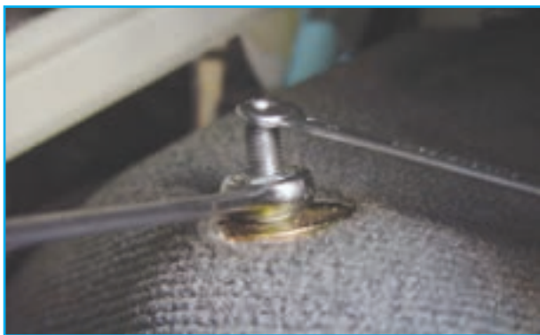
شکل ۳-۶۳- باز کردن مهره اتصال بالای کمک فنر
