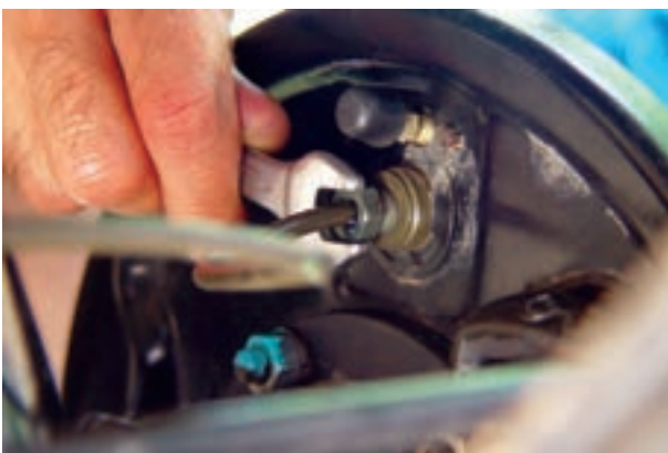
شکل ۱۰۵-۱- باز کردن مهره اتصال لوله ترمز
