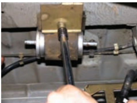
شکل (۲-۶۸) نصب فیلتر جدید
