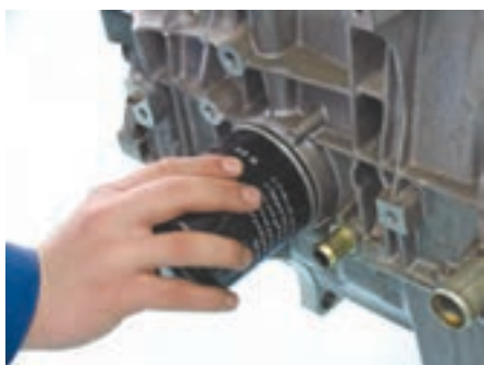
شکل (۲-۵۴) نصب و محکم کردن فیلتر
