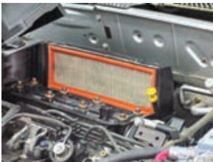
شکل (۲-۶۲) فیلتر سیستم هوارسانی
