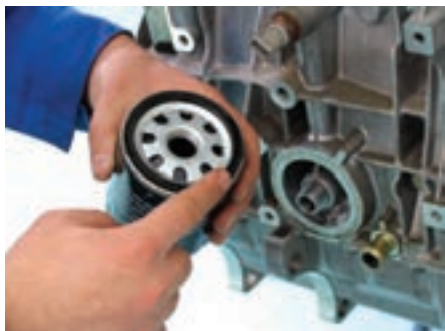
شکل (۲-۵۳) کنترل دندانه و واشر لاستیکی فیلتر
