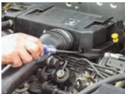
شکل (۲-۶۵) نصب در پوش محافظه فیلتر هوا
