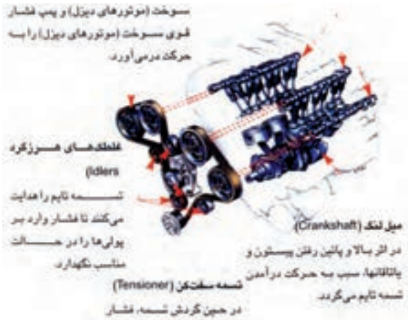
شکل (۱۳-۲ الف) تسمه تایمینگ موتور
